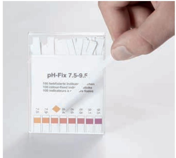
Eine pH-Wert Messung muss mindestens wöchentlich einmal durchgeführt werden (TRGS 611). Die einfachste Möglichkeit ist die Verwendung von Teststäbchen bzw. -streifen, die durch Farbindikation den aktuellen pH-Wert anzeigen.
