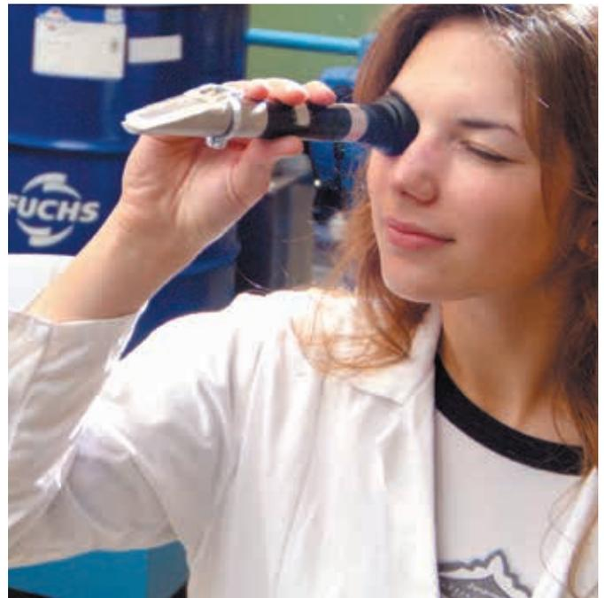
Wichtig bei der Handhabung eines Handrefraktometers ist die Null-Punkt-Einstellung mit reinem Wasser vor der eigentlichen Konzentrationsmessung. Eine stark schmutz- oder leckölbelastete oder eine weniger stabile Emulsion führt dazu, dass der Trennstrich nur diffus erkennbar ist und damit zu einer ungenaueren und unsicheren Konzentrationsbestimmung führt.
